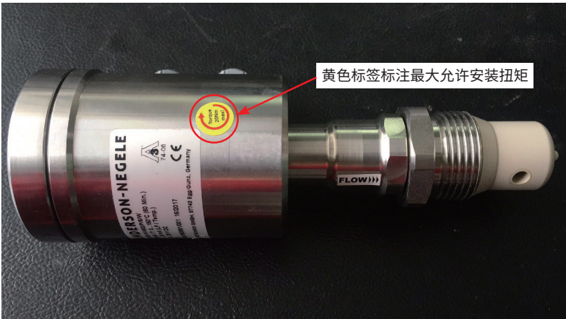
图 1. A-N 黄色标签：标注最大安装扭矩参数
